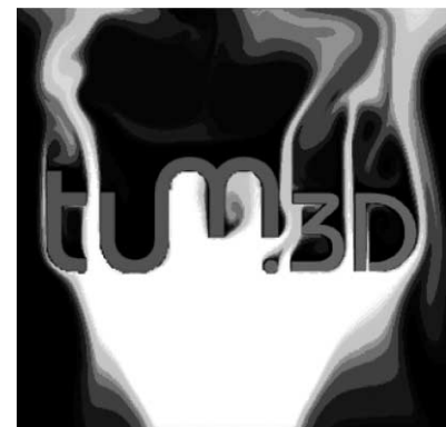
Bild 5 Direkte numerische Lösung der Navier-Stokes Gleichungen für inkompressible Medien und gleichzeitige Visualisierung der Simulationsergebnisse auf einer ATI 9800 PC-Graphikkarte. Die Simulations- und Darstellungsrate liegt für ein 512 × 512 Gitter bei 25 Bildern pro Sekunde.
